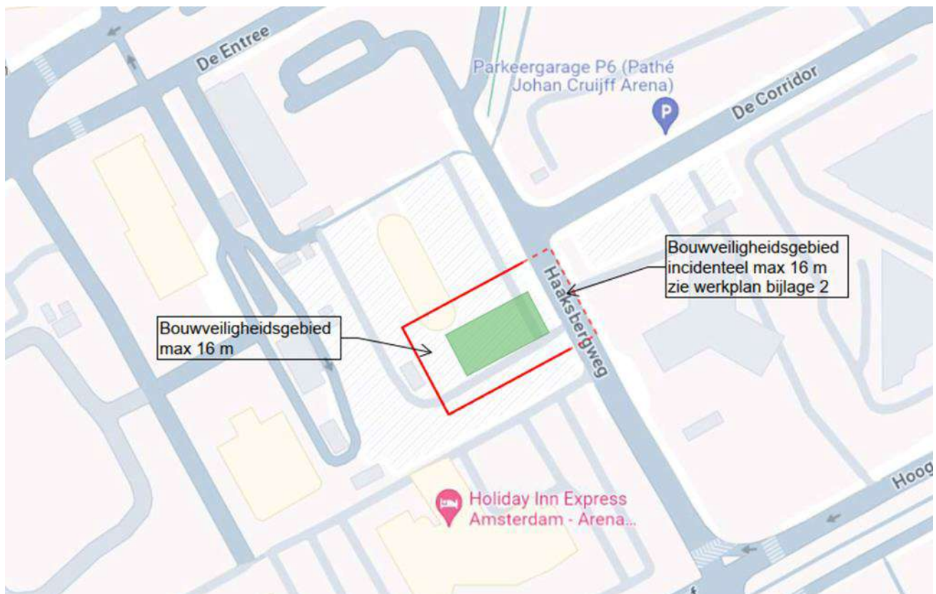
Figuur 1.5 - Bouw woontoren met bouwveiligheidszone in de omgeving
